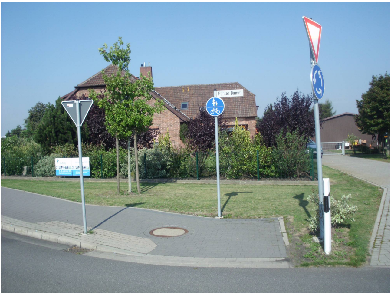
Bild 3: Beide haben ein Vorfahrt gewähren; vom Pöhlerdamm aus steht das Zeichen 240 längs zur Fahrtrichtung und ist nicht erkennbar.
